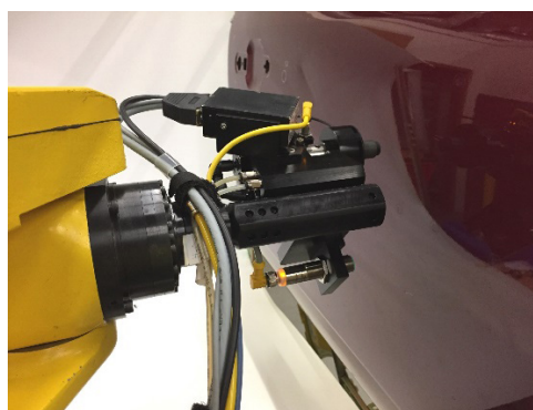
PELT是一款高频测厚仪，可以实现手动或自动高精度涂层测厚。
