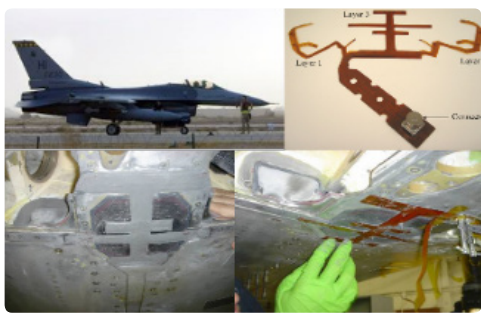
安装在粘接维修表面来监控裂纹生长， 可以用于老龄飞机维修监测。
