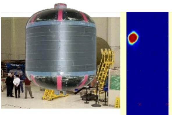
监测复合材料和金属结构在加载条件下所带来的损害，用于各种有人或者无人机、复合材料火箭发动机、火箭、空间飞行器外部的热保护结构监测。
